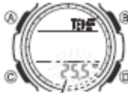
Lämpötilan nykyinen kalibrointi-arvo
